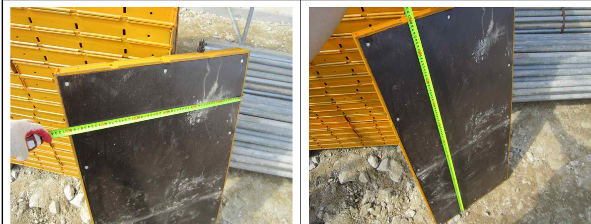
교량 A2 거푸집 자재 검수(600×1200)
